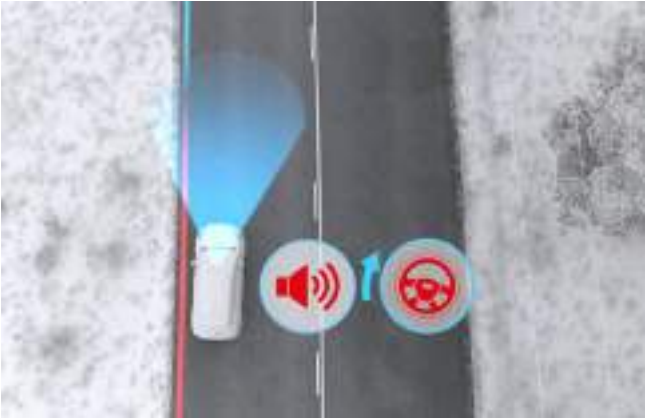
LANE KEEPING ALERT - SYSTEM WSPOMAGAJĄCY UTRZYMANIE POJAZDU NA PASIE RUCHU, Z FUNKCJĄ WYKRYWANIA KRAWĘDZI JEZDNI Wyposażenie standardowe wszystkich wersji
