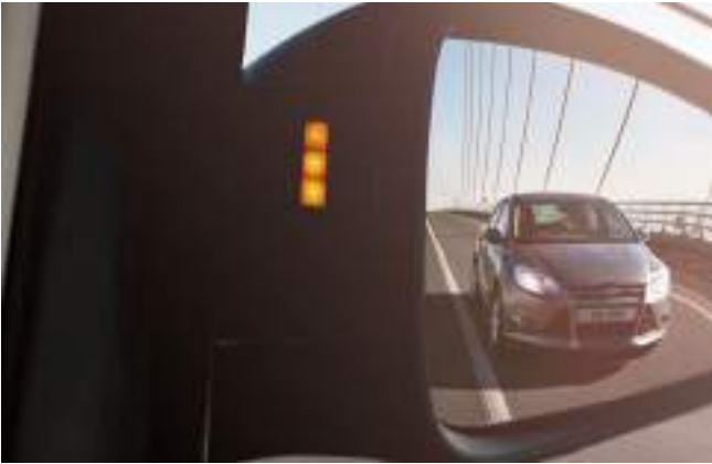
BLIND SPOT INFORMATION (BLIS) Z CTA I EW Wyposażenie standardowe wersji Limited i Active
